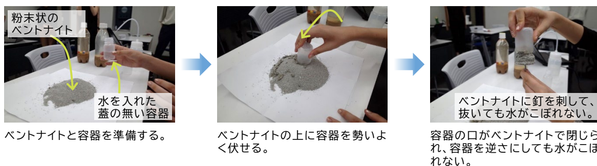
図3 ベントナイトの膨潤性および難透水性を体感する実験
